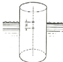
Tómese el origen del desplazamiento vertical en la intersección del eje del cilindro y la superficie del líquido cuando la boya está en equilibrio. Considérese el sentido positivo del desplazamiento hacia abajo. Sea  $x$ , medido en dm, el desplazamiento de la boya en el tiempo genérico  $t$ .
